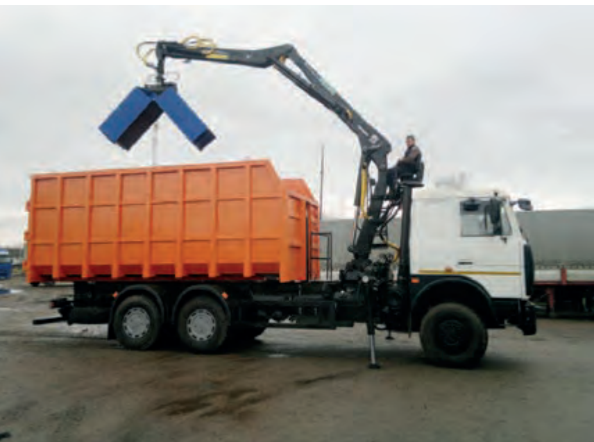
Рис. 1. Выгрузка контейнера для раздельного сбора ТКО в большой контейнер с помощью краноманипуляторной установки
