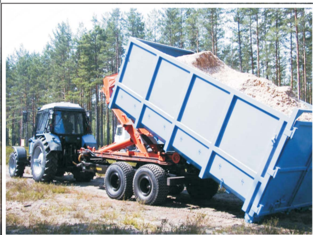
В лесхозах Беларуси все активнее начинает использоваться система «мультилифт», которая в большинстве европейских стран признана наиболее эффективной для погрузки и транспортировки различных грузов в сменных контейнерах.
