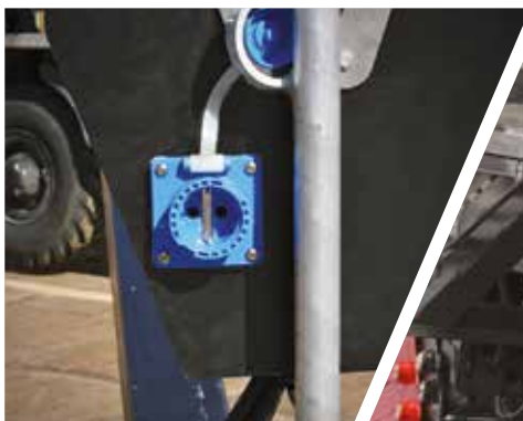
Электрическая розетка. В штатную комплектацию входит розетка напряжением 220 В.
