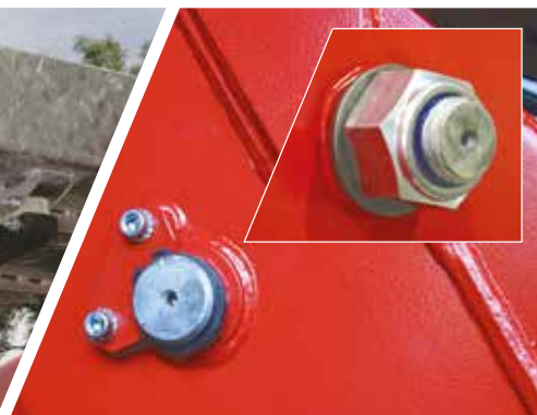
Тройное крепление основных осей АГП. Все оси имеют тройное крепление - шпонка, пружинное кольцо и самоконтрящаяся гайка.
