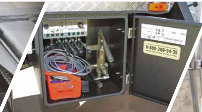
Ящик для перевозки гидрооборудования с внутренними компонентами*. Ящик установлен справа по борту шасси.
