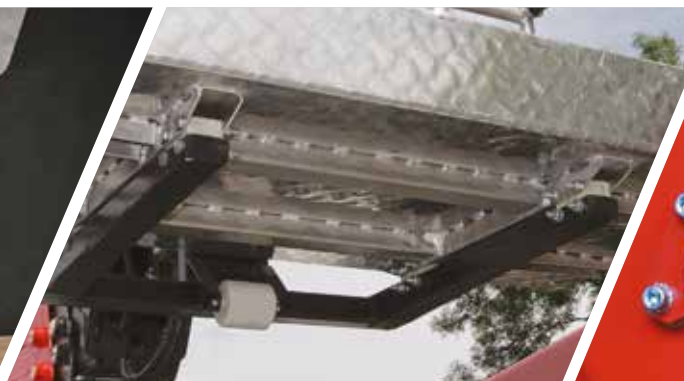
Корзина. Специальные копролоновые проставки под полом обеспечивают электроизоляцию до 1000 В. Ролик снизу узла крепления, предохраняет корзину от удара о землю.
