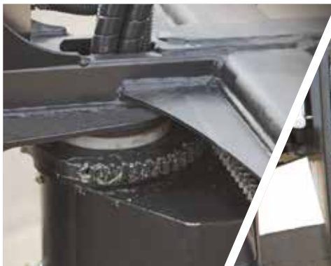
Металлическая шестерня и рейка поворота корзины обеспечивают надежность и четкую работу конструкции.
