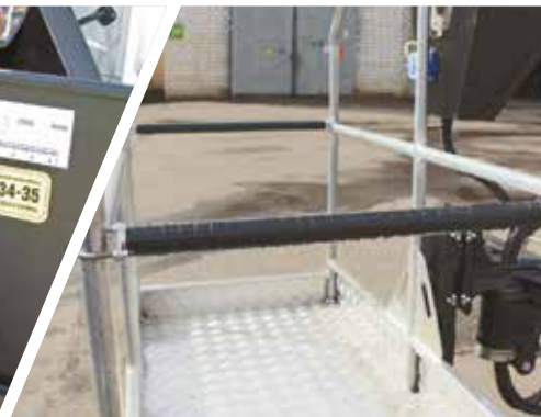
Корзина имеет два входа, что упрощает работу в ней.
